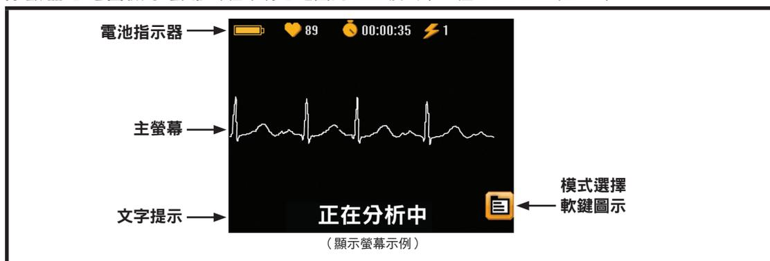
**電池指示器** – 電池指示器指示大約剩餘的電池容量
